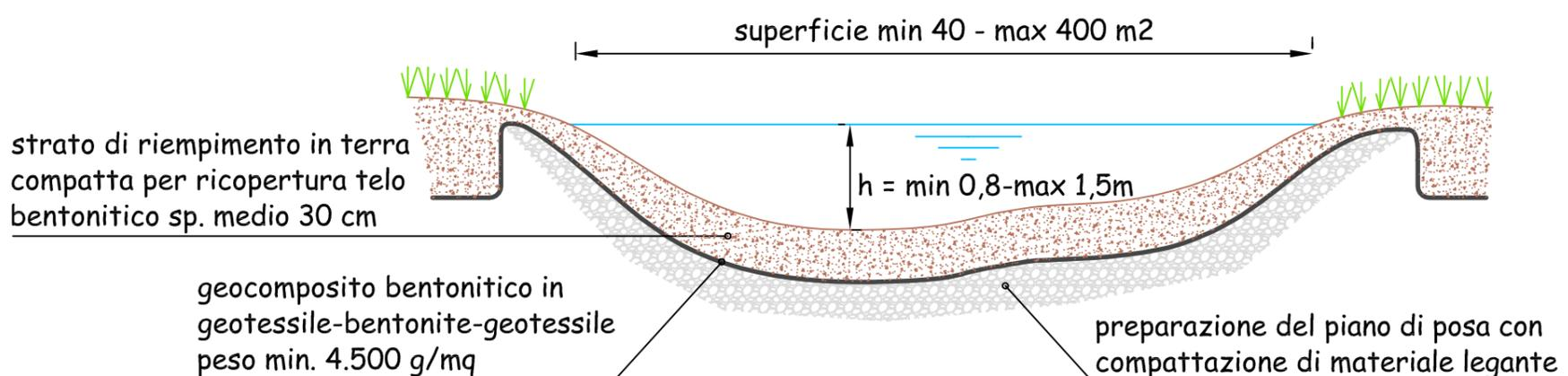
Per terreni che dall'analisi stratigrafica risultano impermeabili il materiale legante di fondo e il geocomposito bentonitico possono essere sostituiti da uno strato di bentonite/argilla sfusa o in sacchi al fine di ridurre la permeabilità del terreno
